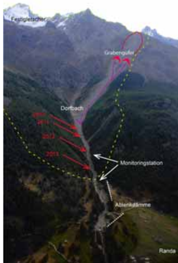
Abb. 2: Sichtbar hohe Wildbachaktivität im Dorfbach Randa. Dargestellt sind das Auslösegebiet am Grabenufer und der Fliessweg von Murgängen, sowie die Lage der Geschiebefront zwischen 2010 bis 2013 (rote Pfeile). Bauliche Schutzmassnahmen auf dem Kegel sind bereits realisiert und das Gerinne wird an zwei Stellen kontinuierlich beobachtet.
