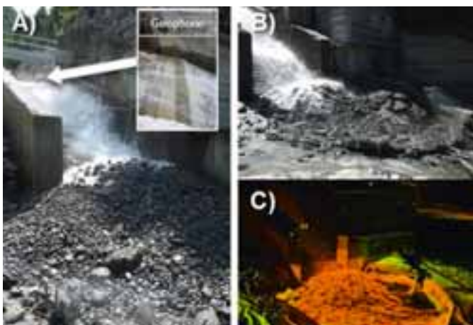
Abb. 4: A) Wasserfassung Riedbach mit Geophonsystem; B) Sediment-Rückhaltezaun und C) Vermessung der Sedimentablagerungen mit einem Laserscanner (Bilder: J. Schneider).
