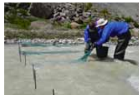
Abb. 2: Geschiebefallen auf dem Gletschervorfeld (Bild: J. Schneider)
