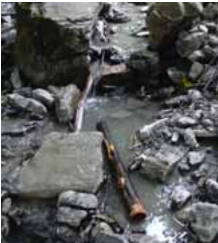
Abb. 1: Im Gerinne liegender Holztracer mit Länge 1 m ohne Äste. Jedes Holzstück war mit einem RFID-Transponder bestückt, der eine individuelle Identifikationsnummer gespeichert hatte. Dadurch war es möglich ein Transportprofil der einzelnen Holztracer über den gesamten Untersuchungszeitraum zu berechnen.
