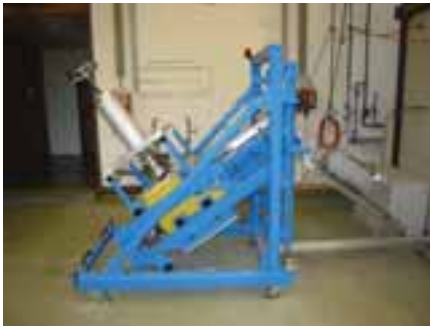
Abb. 2: Versuchseinrichtung zur Durchführung von geneigten Direkt-Scherversuchen an be- und unbepflanzten Bodenproben.
