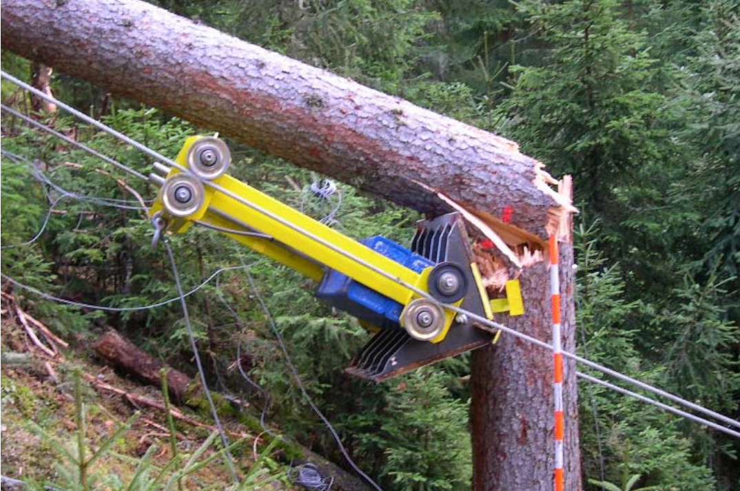
Abb.1: Anprallversuch: Auf den zwei Führungseilen frei fahrender Anprallwagen unmittelbar nach dem Test. Der 517 kg schwere Anprallwagen prallte mit einer Geschwindigkeit von 21,4 m/s auf den Testbaum mit einem Durchmesser DBH = 0.43 m. Die Energie von 118 kJ reichte aus, um den Baum zu brechen. Dank dieses realitätsnahen dynamischen Tests kann das Energieabsorptionsvermögen von Bäumen bei Steinschlag berechnet werden.
