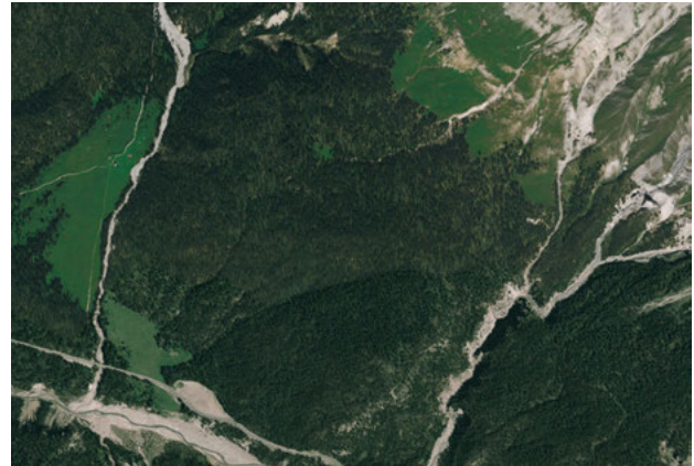
Abb. 4: Problematik der Geländemodellgenerierung aus Stereokorrelation bei dichter Vegetation oberhalb von 2000 m ü. M. Von oben nach unten: Ausschnitt SWISSIMAGE 50 cm, Resultat aus der Stereokorrelation mit gut sichtbarer Vegetation oberhalb von 2000 m ü. M., integrierte Daten aus DHM25 nach der Eliminierung der Vegetation.
