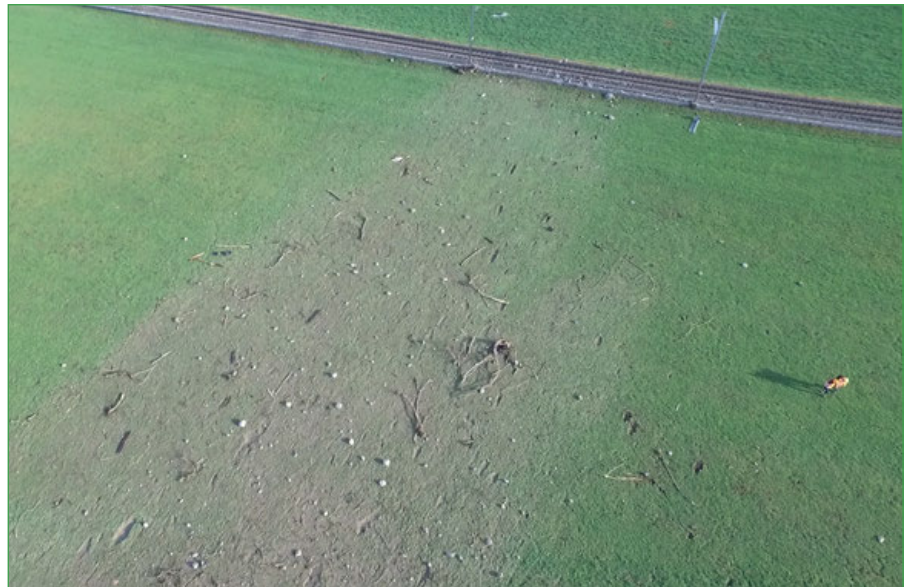
Abbildung 8: Drohnenaufnahme des Bereichs zwischen Kantonsstrasse und Bahnlinie mit deutlich sichtbaren Aufschlagspuren der Steine. Foto: ZSO EMME am 12.1.2016.
