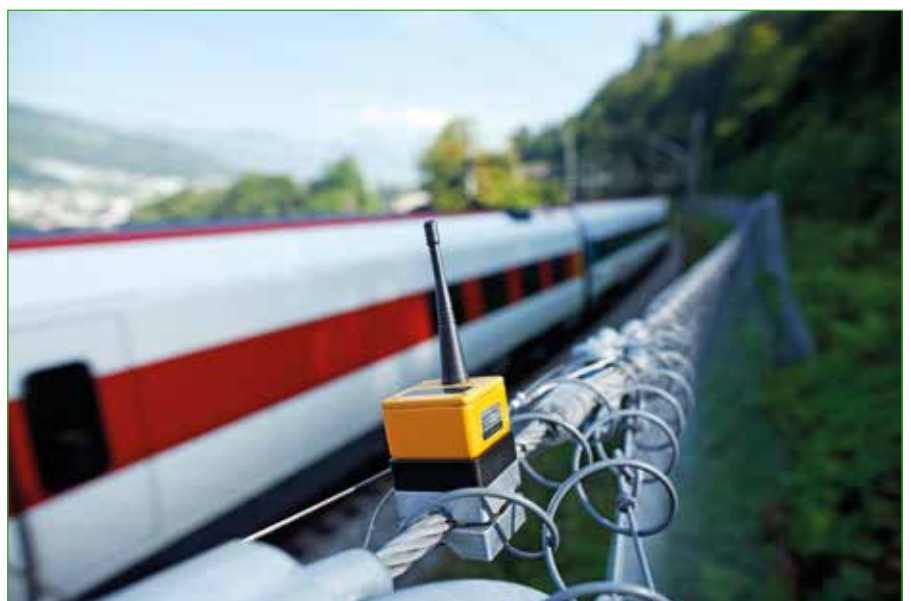
Abbildung 1: Sensor einer NGA-Anlage, welcher Einschläge in der Steinschlagschutzanlage detektiert und die aufgezeichneten Daten per Funk an eine Basisstation weiterleitet.
