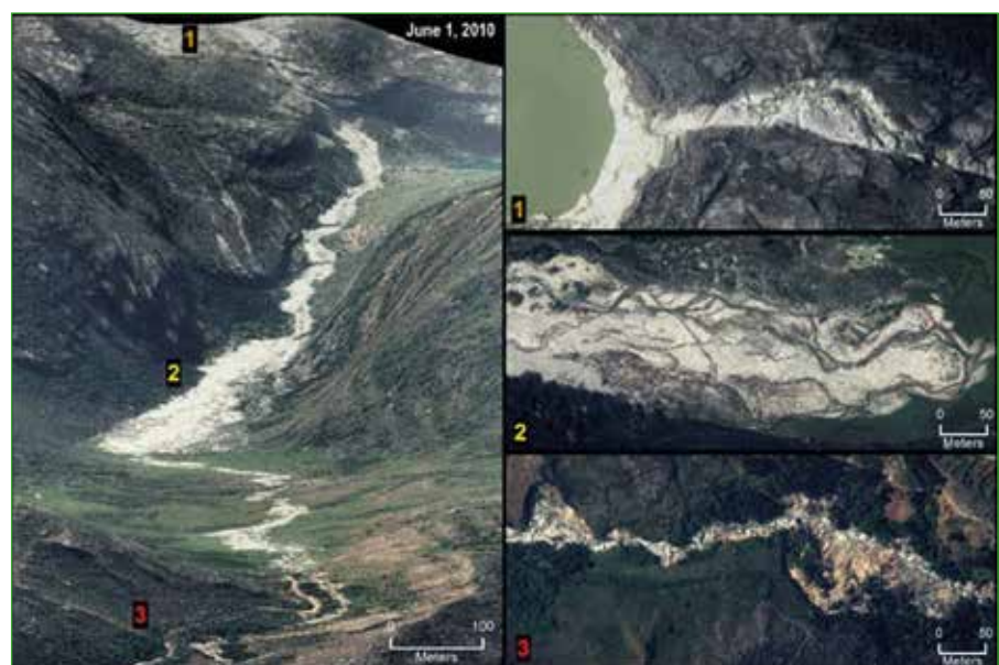
Abbildung 3: Erosions- und Ablagerungsmuster der verschiedenen Fließcharakteristika. (1) Erosion von Lockermaterial im Bereich des Dammes; (2) Übersarung bei Neigungsabnahme vor Flachstück; (3) Erosions- und Sedimentationsspuren in einem steileren Abschnitt oberhalb der Stadt Carhuaz. Quelle: Carey et al. 2012.
