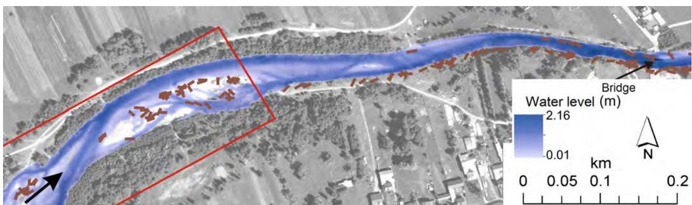
Abbildung 3: Beispiele eines Simulationsergebnis mit Iber-Wood. Ablagerungsmuster von Schwemmholzstücken (braune Striche) und Identifizierung eines Gerinneabschnitts (rotes Rechteck) mit hoher Retentionskapazität (Ruiz-Villanueva et al., 2017).
