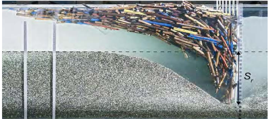
Abbildung 4: Foto eines Modellversuchs mit natürlicher Verklauung und beweglicher Sohle mit Kolk am Rechen.
