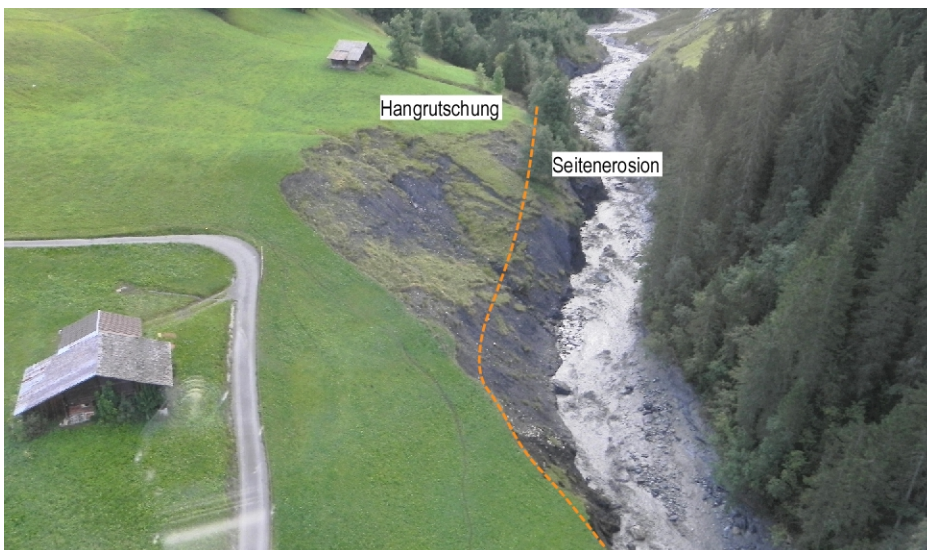
Abbildung 5: Abgrenzung von Seitenerosion und Hangrutschung. Beispiel Schwarze Lütschine in Grindelwald. Foto Nils Hählen.
