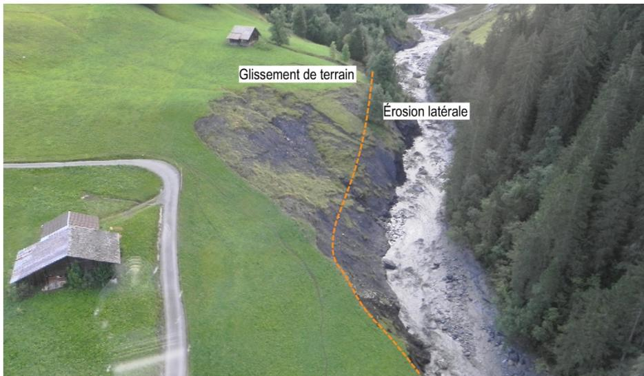
Figure 5: Différence entre érosion latérale et glissement de terrain. Exemple de la Lüttschine noire à Grindelwald. Photo Nils Hählen.
